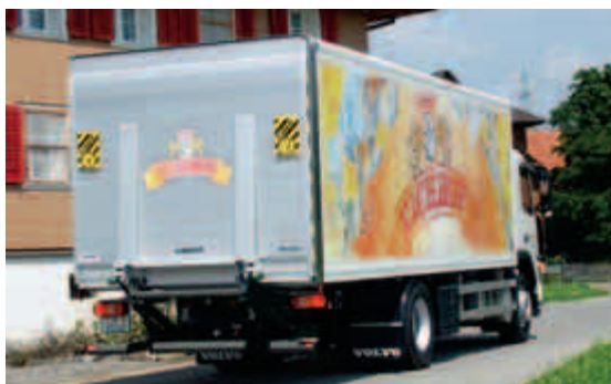
Zweckmässig: Mammut-Hebebühnen erleichtern den Eichhof-Fahrern die Getränke-Lieferung. Die Hebebühnen können mittels Fernbedienung geschlossen werden, damit sich Passanten nicht aus dem Lastwagen bedienen können.
