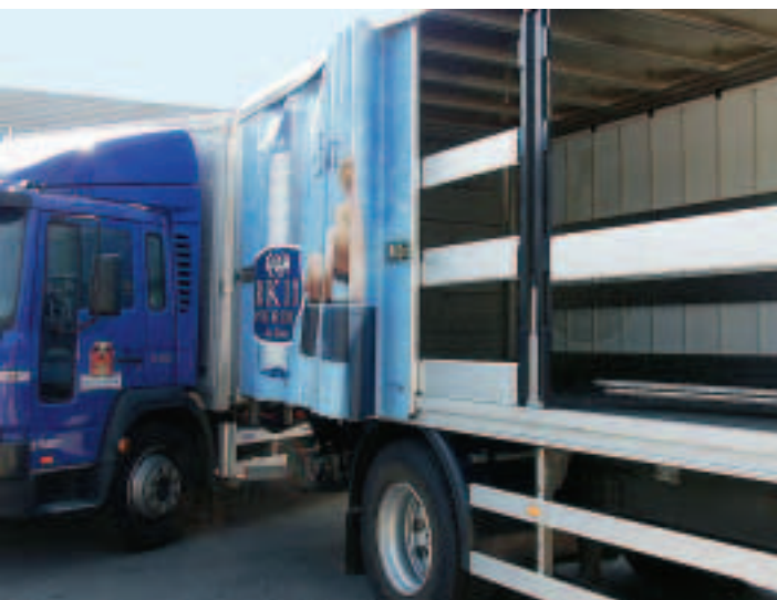
Wie ein Vorhang: Ohne Kraftaufwand lässt sich die Vario-Plan-Schiebplane nach hinten schieben.
